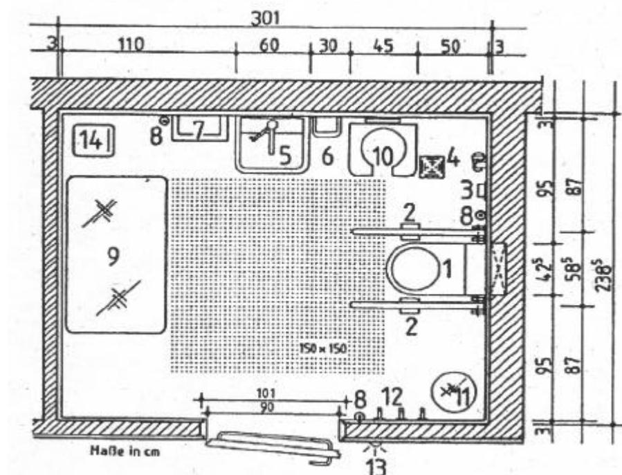
1 WC mit beidseitigem Umsetzungsfreiraum = 95 cm; Spülung automatisch oder durch überfahrbaren Bodenkontakt auszulösen.
