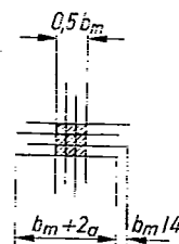
Bild 49. Zusätzliche Bewehrung unter einer Einzellast
