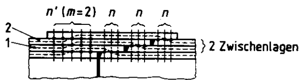
Bild 3. Erhöhung der Anzahl der Verbindungsmittel bei mittelbarer Stoßdeckung
