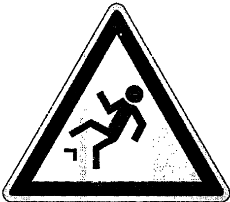
W15 Warnung vor Absturzgefahr
